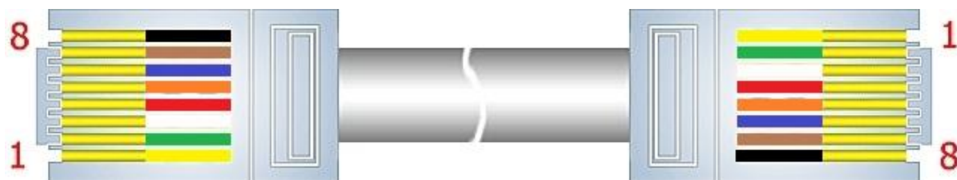
Рисунок 2. Схема обпресування кабелю комутації пульта та турнікета.
